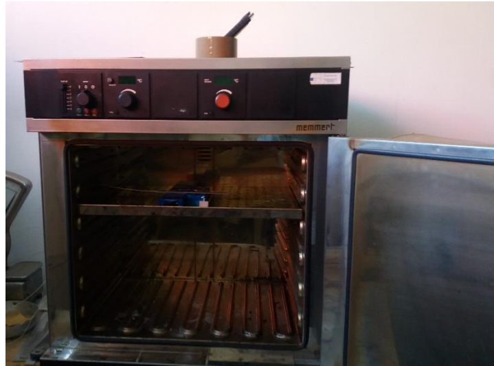
Figure 3.6: Industrial Oven; AMATECH Politecnico di Milano
