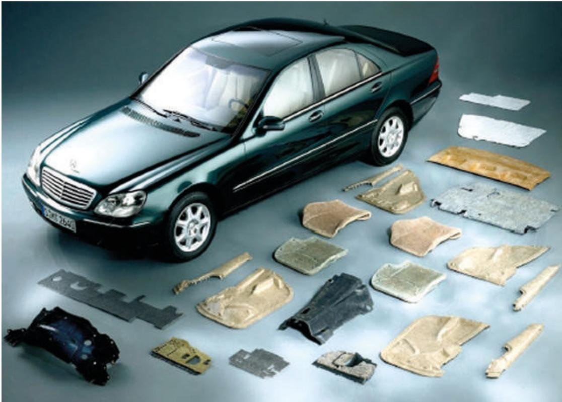
Fig. 15: la mercedes Classe E del 1996, una delle prime con parti in compositi con fibre naturali. Fonte: [www.globalhemp.com/2011/02/automotive-composites.html](http://www.globalhemp.com/2011/02/automotive-composites.html)
