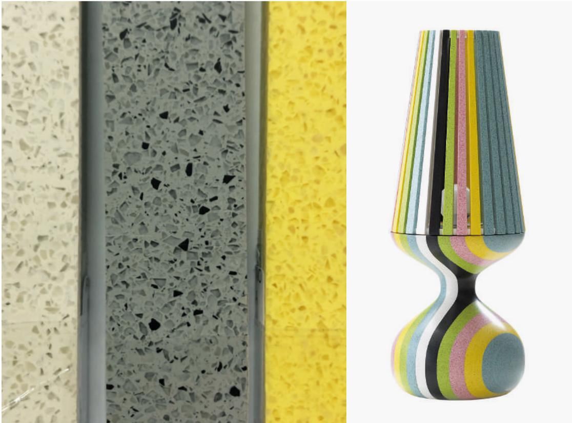
Durat offre un'ampia gamma di colori e possibilità di poliestere riciclato. Il materiale riciclato viene ridotto in piccoli granuli che conferiscono l'aspetto caratteristico di questo materiale. La produzione offre differenti opzioni di pannelli e arredo bagno. Durat è sicuro per quanto riguarda le emissioni di VOC e adatto al contatto alimentare.
