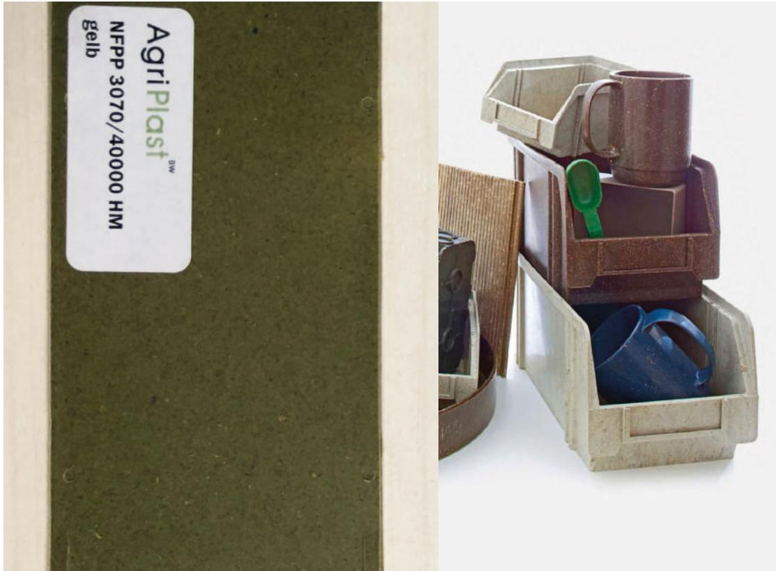
AgriPlast NFPP è un composito di fibre di cellulosa ottenuta da erba di prato e polipropilene in diverse percentuali, in questo caso 30% di fibre e 70% di polipropilene. Il polipropilene utilizzato in questo caso è riciclato, ma la base potrebbe essere anche PE o PCL sempre riciclati oppure PLA. Grazie alle fibre utilizzate presenta ottime caratteristiche superiori a quelle delle plastiche convenzionali. Questo è facilmente osservabile nell'utilizzo di questo tipo di materiale nel packaging.
