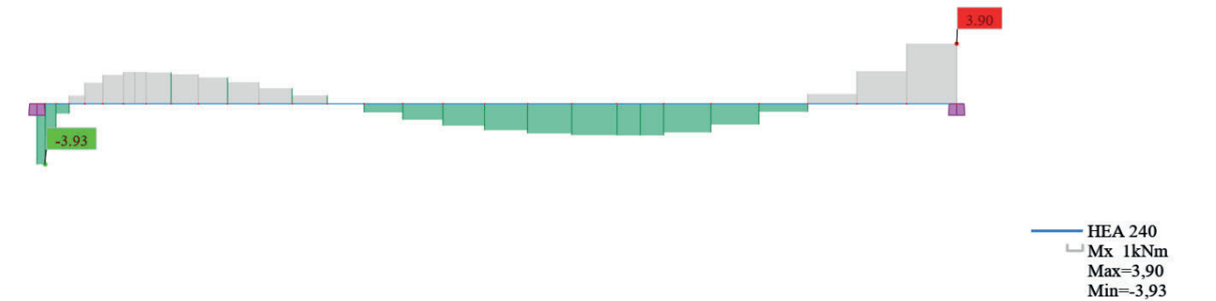
F32-Grafico del momento torcente trave ad asse curvilineo SLU: HEA240
