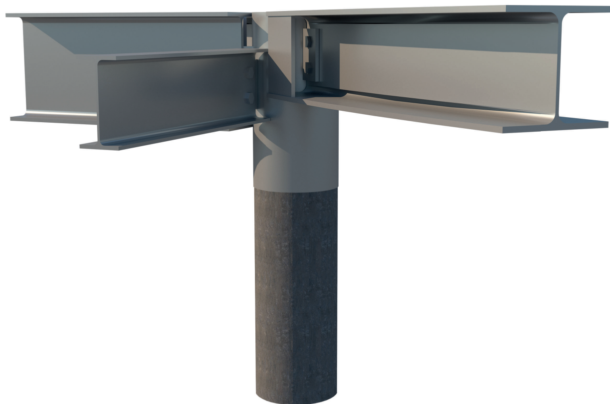
F59-Vista renderizzata nodo travi pilastro
