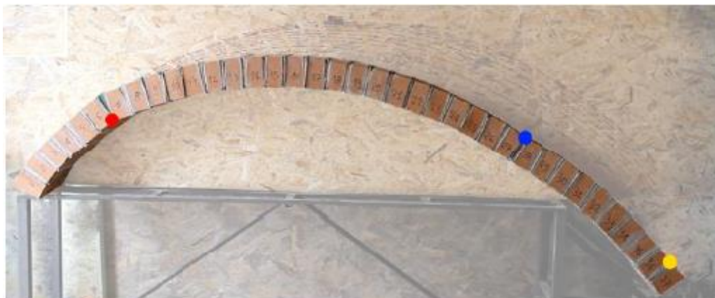
Figura 1.13. Risultato sperimentale: applicazione di uno spostamento verticale all'appoggio di destra e individuazione delle cerniere (Zampieri et al., 2018)
