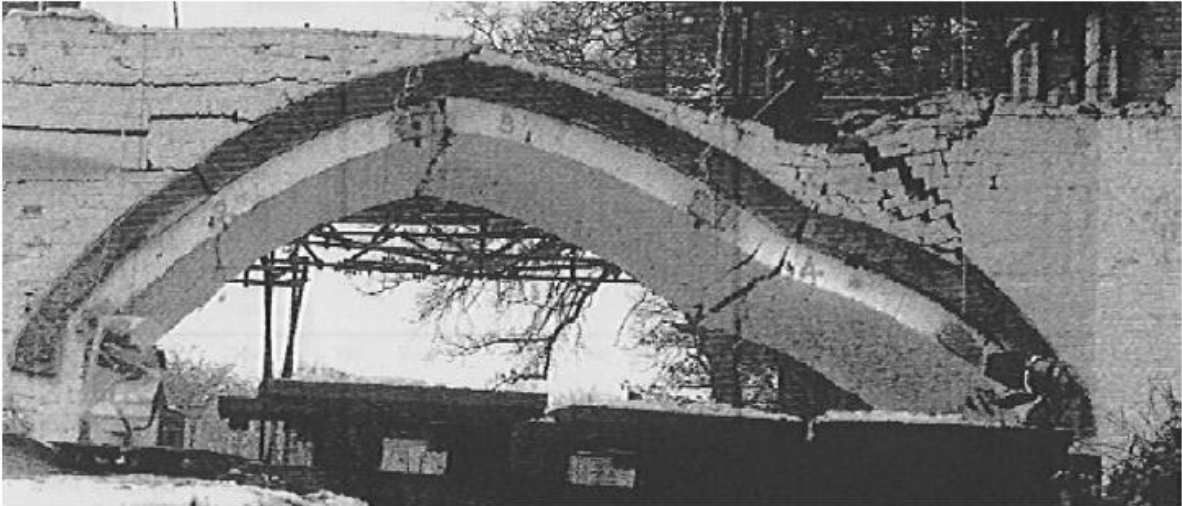
Figura 3.16 Prestwood bridge: meccanismo di collasso
