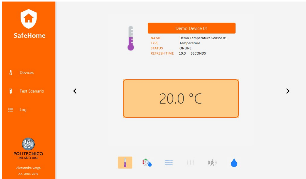
Figura 27: la pagina riepilogativa dei dati del sensore di temperatura all'interno di Demo Device 01.
