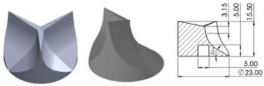
Figura 6 modelli CAD in configurazione finale, di valvola tricuspide e bicuspide. A sinistra, disegno tecnico.
