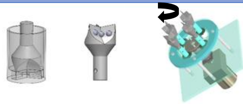
Figura 2 Il protocollo prevede l'uso della tecnica di “ dip-coatig ”, l'inclusione delle calcificazioni e la polimerizzazione del modello attraverso uno Spinning Device appositamente progettato.
