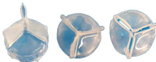
Figura 10 Modelli di valvole aortiche ottenuti con dip-spin coating di Sorta Clear 18.
