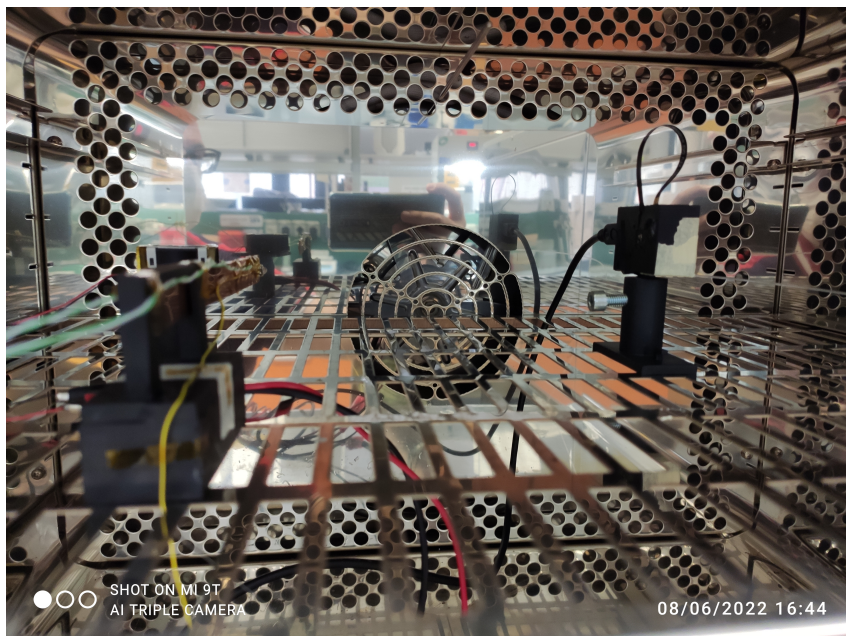
Figura 4.36: Setup interno per le misure LED vs temperatura con relative stampe 3D.
