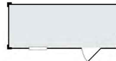
Figura D5.02: Planimetria del modulo prefabbricato monoblocco degli spogliatoi (open space). Fonte: Autori.
