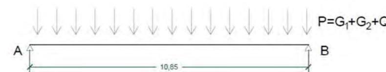
Figura D2.51: Schema statico della trave T12. Fonte: Autori.
