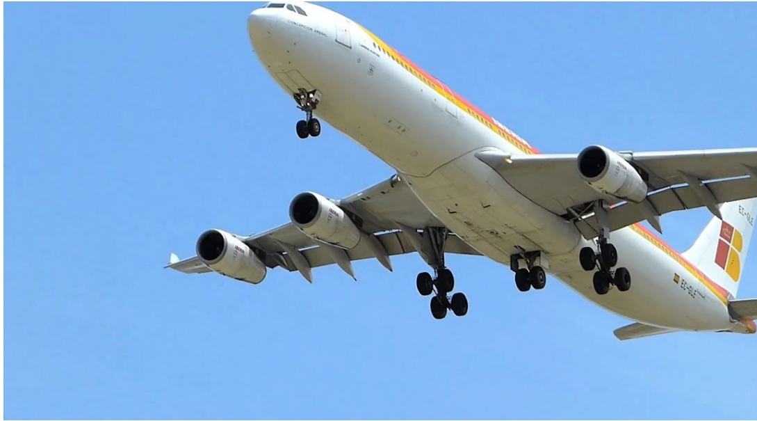
Figura 2.34: Configurazione carrelli 2D-D1 su un aeromobile A340-200 Fonte:[13]
