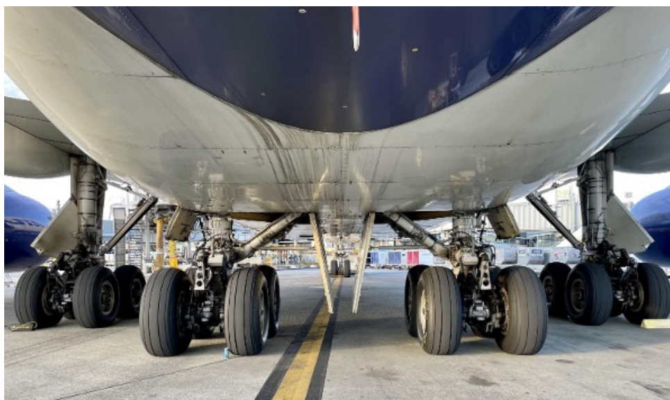
Figura 2.37: Configurazione carrelli 2D-D2 su un aeromobile Fonte:Web
