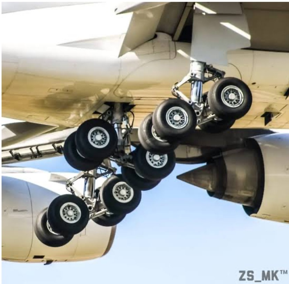
Figura 2.35: Configurazione carrelli 2D-2D1 su un aeromobile A340-500 Fonte:Web
