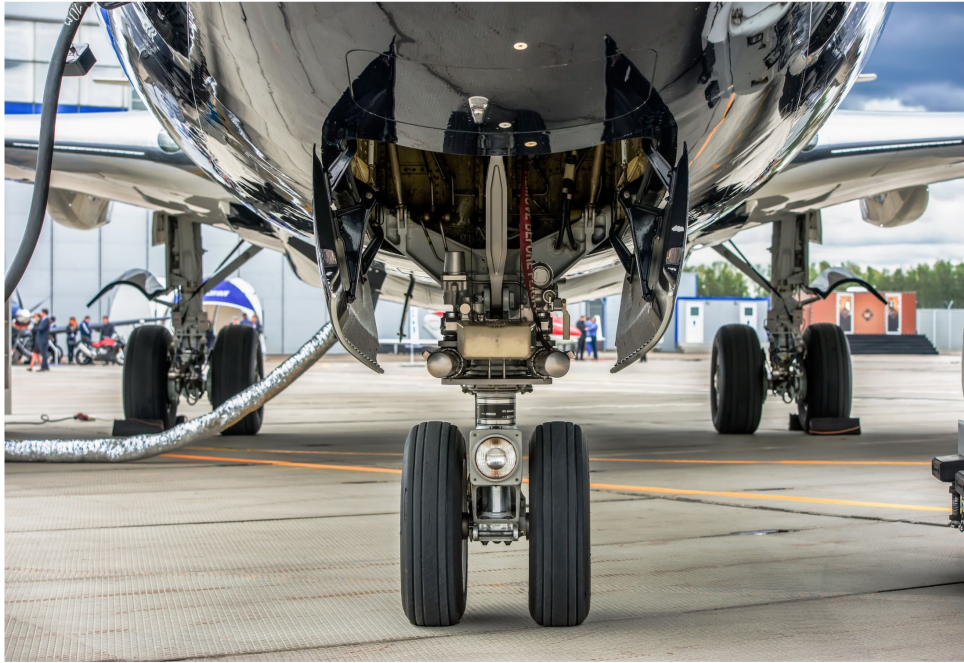
Figura 2.30: Configurazione carrelli D su un aeromobile Fonte: [10]
