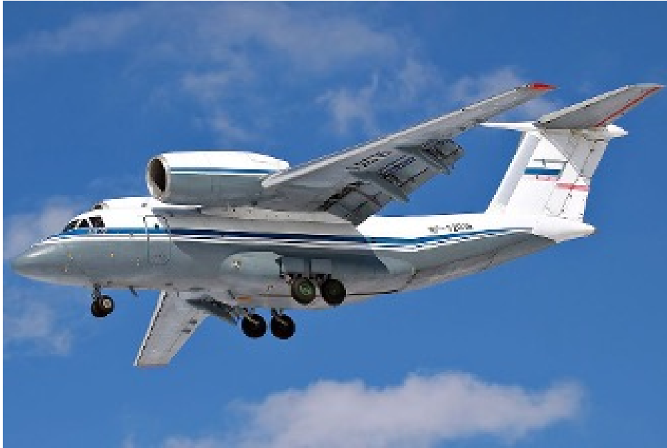
Figura 2.33: Configurazione carrelli 2S su un aeromobile Fonte:[12]
