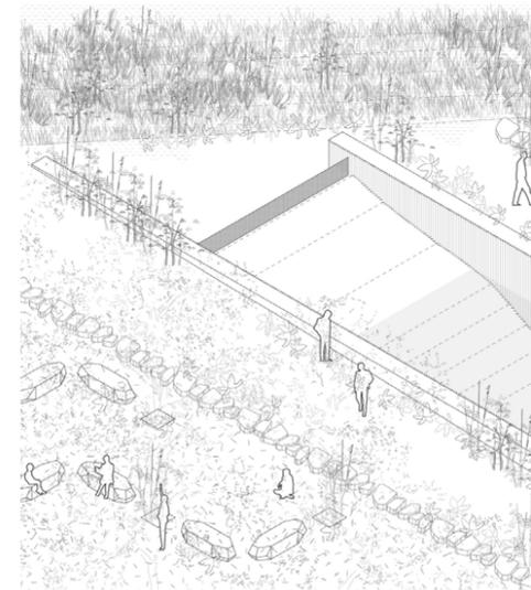
Un elemento di fondamentale importanza all'interno del disegno di paesaggio è quello delle vasche di laminazione, opere idrauliche volte alla realizzazione di un ampio bacino scavato in profondità per permettere il contenimento delle acque che, durante una piena, il fiume o, in questo caso, un canale artificiale come la gora, non sono in grado di contenere nel proprio alveo.
