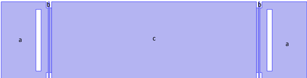
Figura 4.1 Domini del sistema (colorati in azzurro) a cui è stata applicata la fisica "Tertiary Current Distribution, Nernst-Planck (tcd)"
