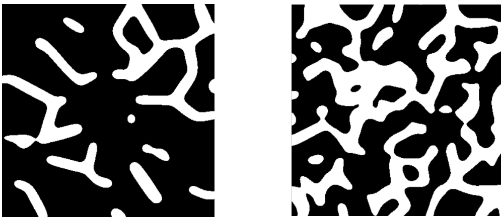
Figura 4.2: Immagini simil micro-CT ottenute per due provini con N° seed = 200 (a sinistra) e N° seed = 650 (a destra)
