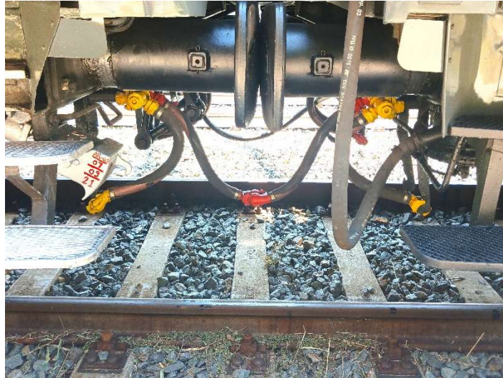
Figura 33. Condotta generale collegata fra due vetture.
