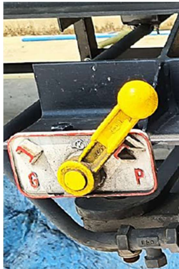
Figura 36. Dispositivo Merci-Viaggiatori: G (goods); P (passengers).
