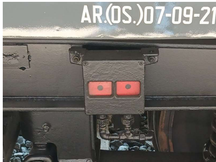
Figura 40. Indicatori di serraggio dei freni: il colore rosso comunica che il veicolo è frenato.
