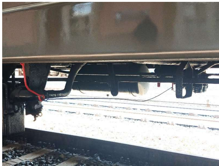
Figura 35. Funicella della doppia valvola di scarico che viene azionata tirando la maniglia rossa.
