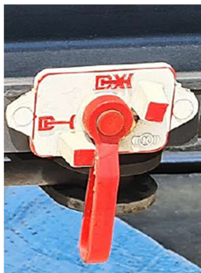
Figura 34. Rubinetto di isolamento del freno di un carro.
