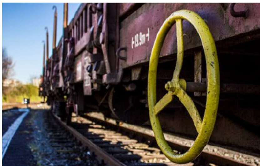
Figura 41. Volantino per l'inserzione del freno di stazionamento.
