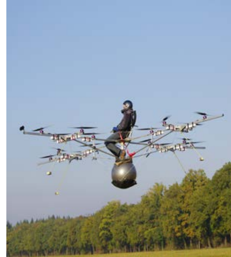
Figura 1.2: Prototipo iniziale di velivolo eVTOL multicottero monoposto (Volocopter VCI), dimostratore tecnologico per Urban Air Mobility.
