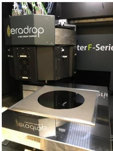
Figura 3.5: Il substrato di silicio posizionato sul chuck prima della stampa.
