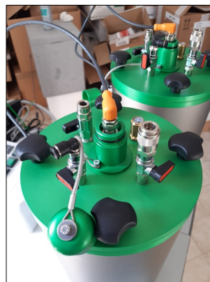
Figura 3.2: a) Fotografia dell'Apparato 2 durante una fase di prova, b) dettaglio degli attacchi pneumatici sulla testa dell'Apparato 2
