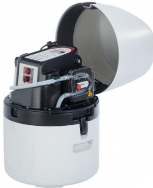
Figura 2.4. Campionatore portatile Maxx utilizzato per il campionamento del refluo in ingresso al pilota.
