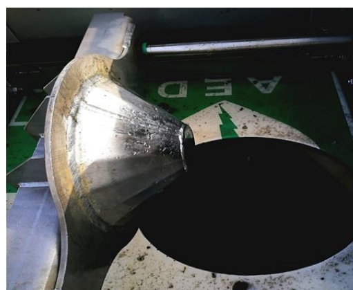
(4): Pressa a vite (a sinistra) con particolare del cono in pressione (a destra).
