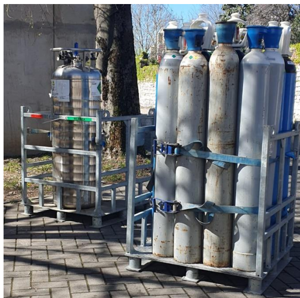
Figura 1.18: Sicurezza per il deposito delle bombole
