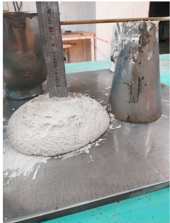
(d) Slump composition CaO 5% + MgO 5%
