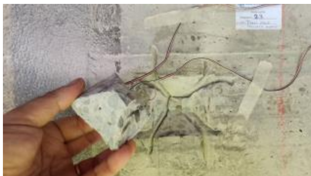
Figura 3.17: Rilascio tensionale sul calcestruzzo, provino troncopiramidale. Immagine tratta da [22].
