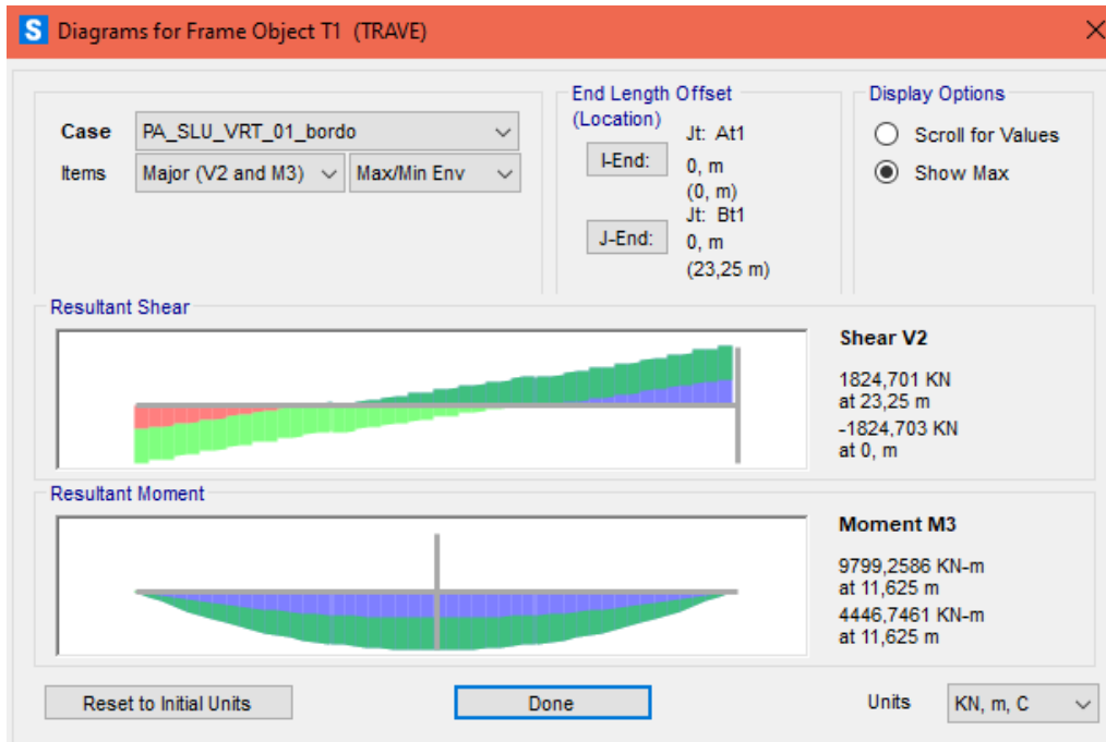
Figure B.1: Trave di bordo – Adeguato.
