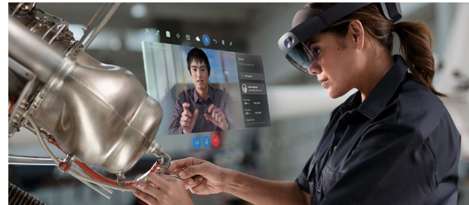
Figura 08.12 - f. Esempio di display virtuale inserito in un contesto di mixed reality per sostituire la necessità di un display fisico, impossibile da trasportare e maneggiare in determinate situazioni.
