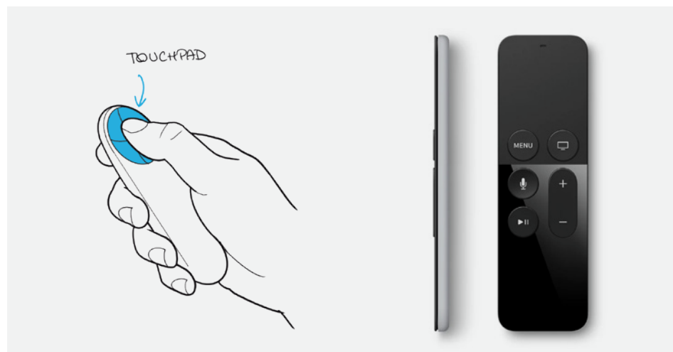
Figura 09.8 - A sinistra, applicazione di un touchpad nella metà superiore del controller. A destra un'implementazione simile che troviamo nel controller per l'Apple TV progettato da Apple.
