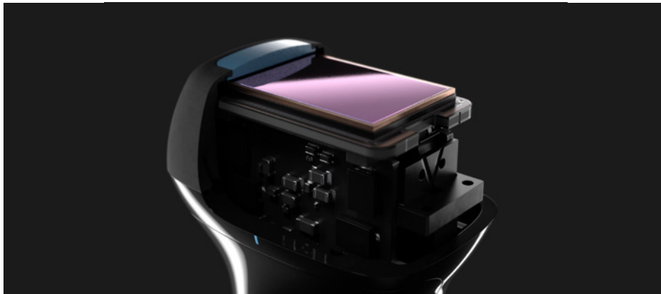
Figura 07.4 - Rappresentazione della tecnologia Ultrasound-on-Chip™ che utilizzata nelle sonde Butterfly iQ e iQ+ al posto del cristallo piezoelettrico tradizionale. Questo permette di simulare il comportamento di sonde lineari, fasate e convesse tutte con la stessa sonda.
