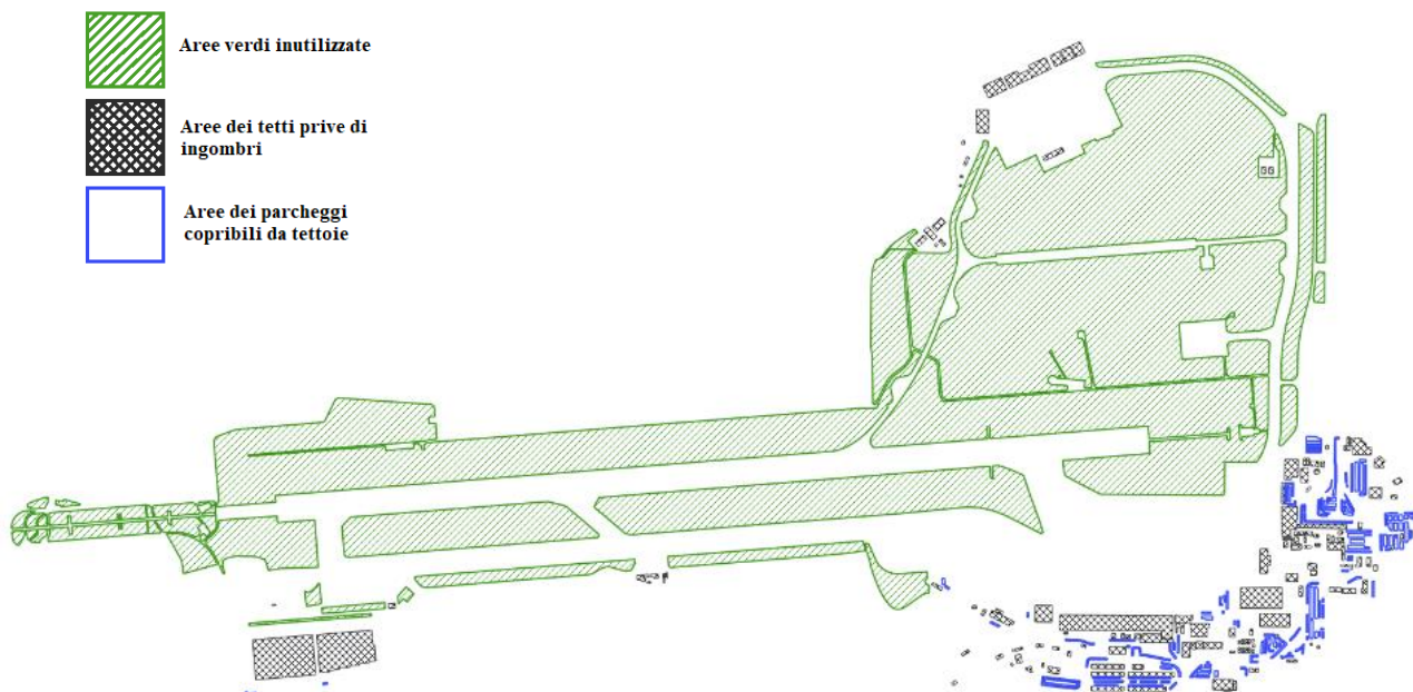
Figura 2.5b: Superfici selezionate come adeguate all'installazione di pannelli FV nell'aeroporto di Milano Linate.
