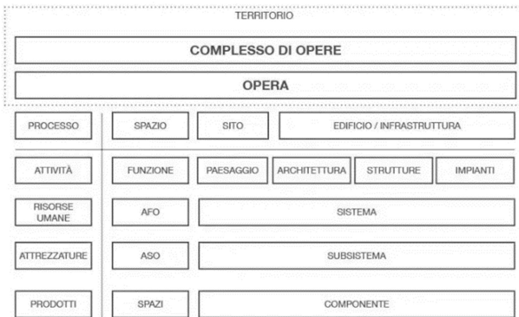
Figura - Struttura di scomposizione informativa dell'opera
