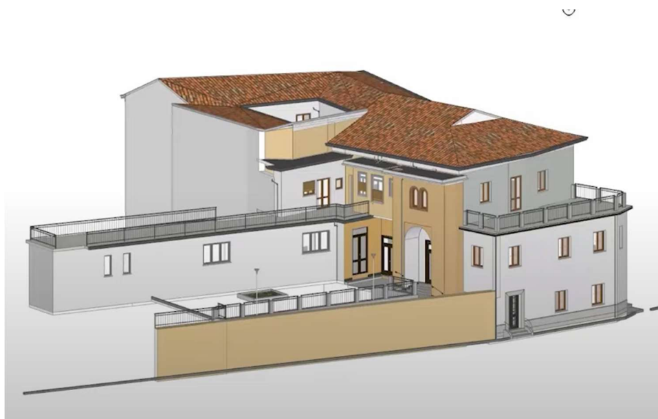
Figura 4-21. Modello BIM da Nuvola di punti. Fonte: www.acca.com
