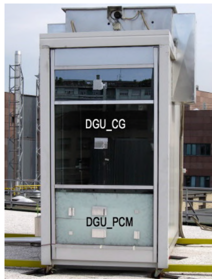
Figura VI.1.28. Testing di moduli integrati con PCM Fonte immagine: polito.it
