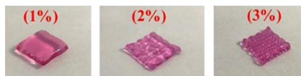
X. Cubi di alginato stampato per estrusione con concentrazione crescente da sinistra verso destra. La concentrazione al 3% permette di ottenere una struttura più precisa e porosa [21].
