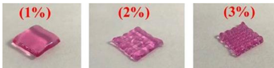
Figura 20. Cubi di alginato stampato per estrusione concentrazione crescente da sinistra verso destra. La concentrazione maggiore di alginato (3%) permette di ottenere una struttura più precisa e porosa [21].
