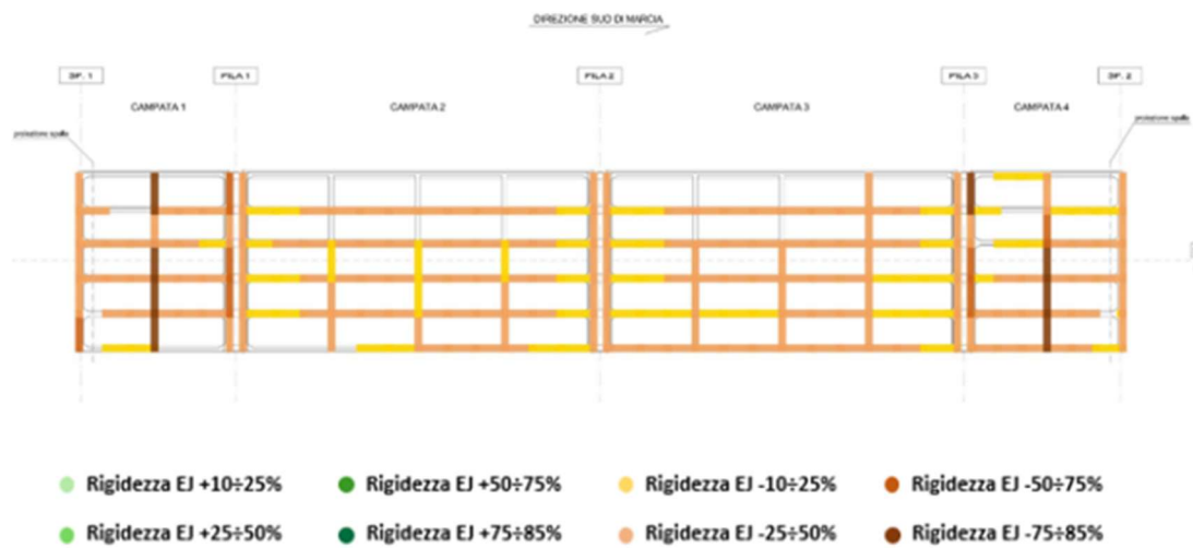
Figura 4-23: Rappresentazione dei valori della rigidezza dopo il model updating
