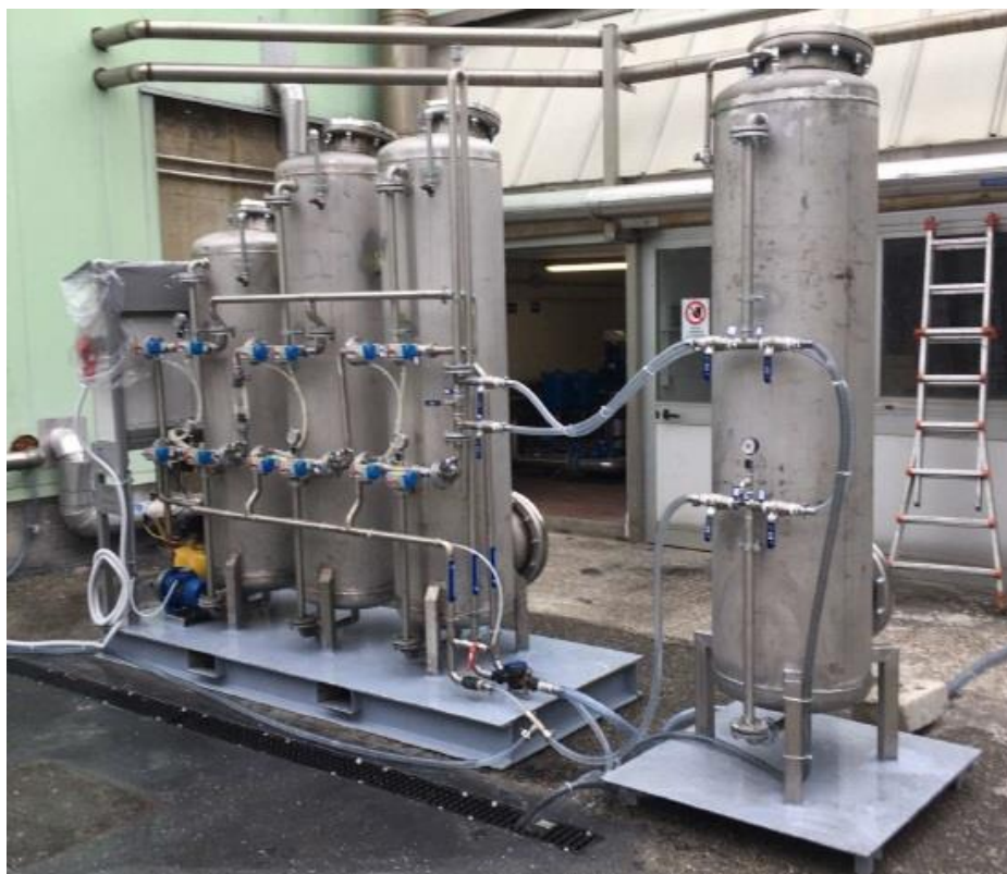
Figura 52: PFAS remover a Parma (PR) con colonna aggiuntiva.
