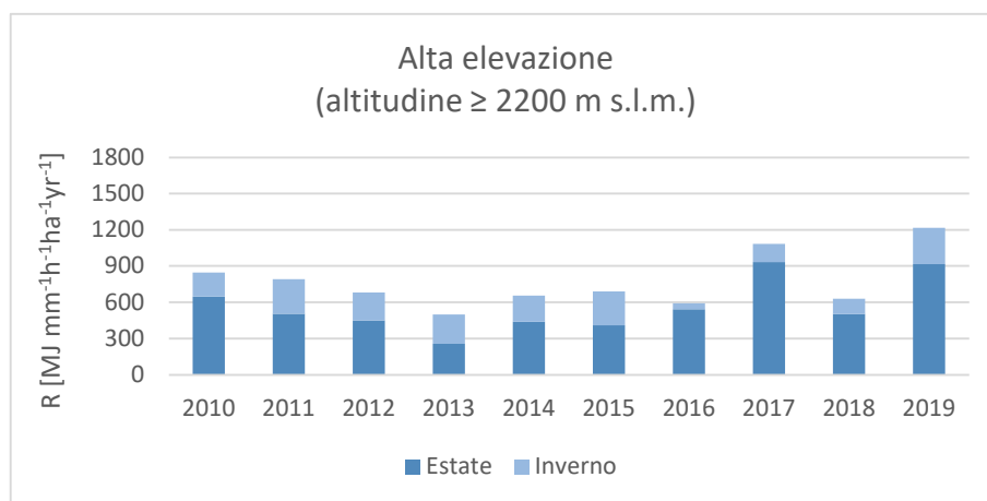
Figura 43. Grafici a barre dell'andamento annuale del fattore R [ MJ\ mm^{-1}h^{-1}ha^{-1}yr^{-1} ] secondo le diverse fasce di elevazione in cui è suddiviso il bacino, si distingue il contributo estivo e da quello invernale.
