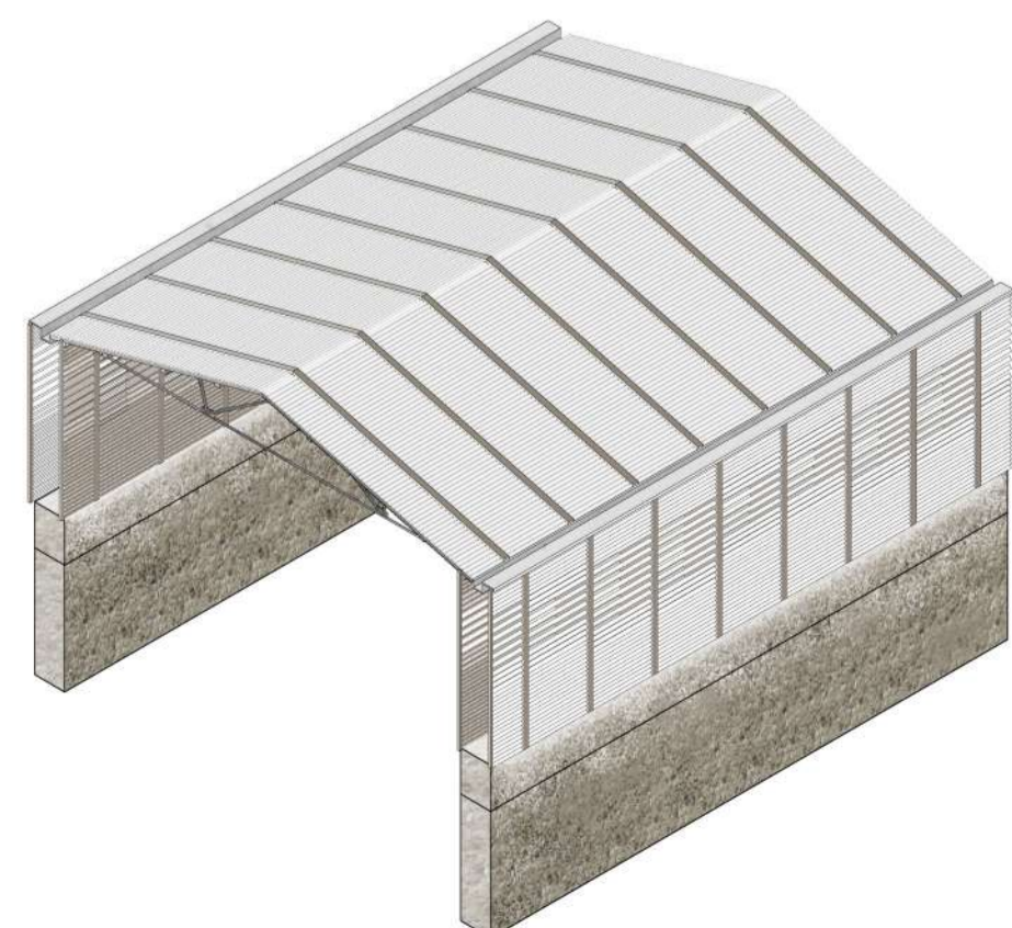
Copertura in lamiera
