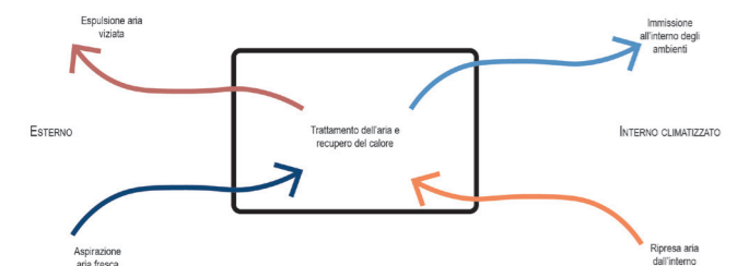
fig. 5.1 Schema funzionamento impianto di VMC
