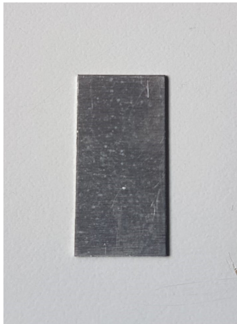
Figura 3.1: Campioni in lega di magnesio AZ31B di dimensioni 20*10 mm e spessore 0.5 mm
