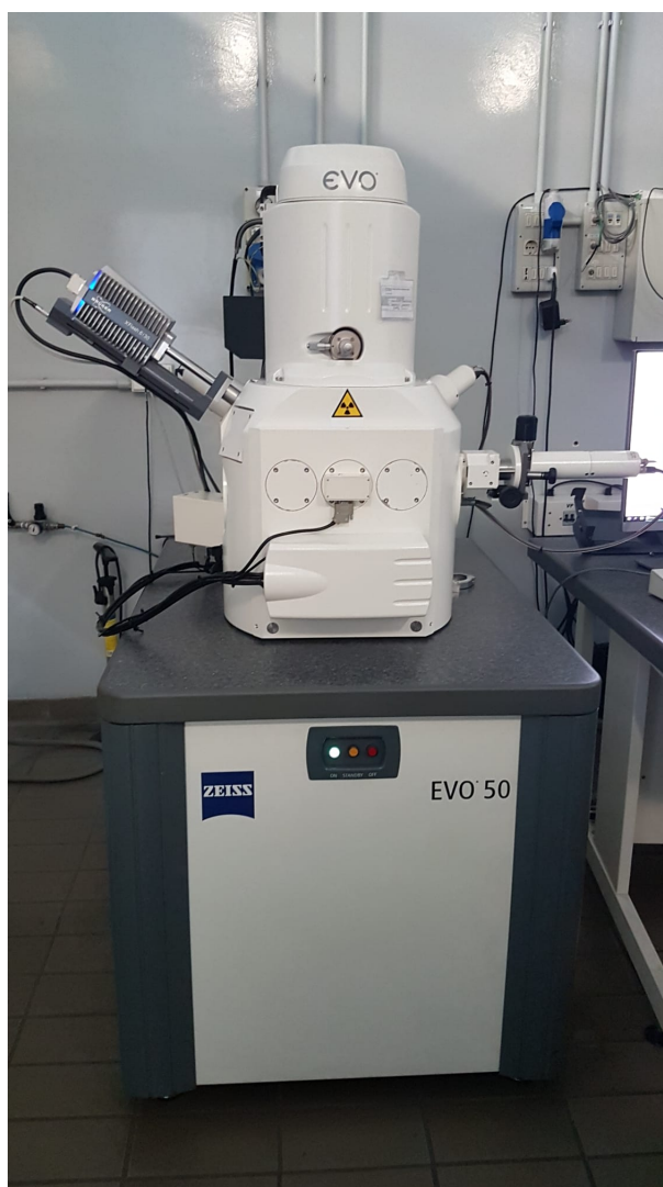
Figura 3.6: SEM ZEISS modello EVO50 con microanalisi EDS Bruker Quantax 200
