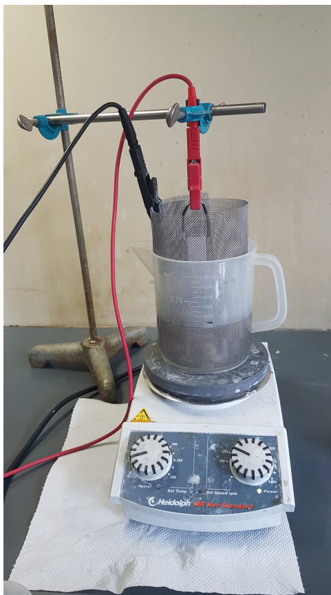
Figura 3.3: Set-up sperimentale della MAO
