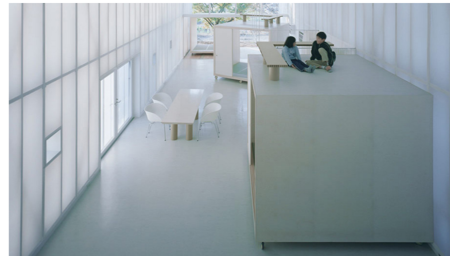
Figura 5.09: Vista delle stanze mobili in cartone della Naked House. Shigeru Ban, Kawagoe, 2000.
