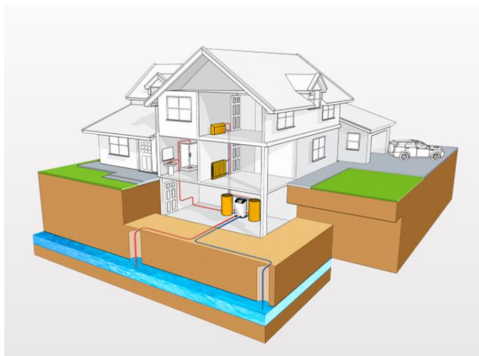
Figura 10 Esempio di impianto a circuito aperto (Fonte: Geonovis)
