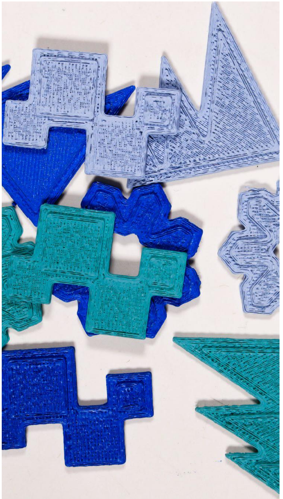
Fig. 18 Forme del Freddo; realizzate in PLA stampato 3D, non presentano la finitura superficiale desiderata ma si distinguono nettamente dal feltro per la restituzione termica tattile. Il colore è stato realizzato tramite vernice spray.
