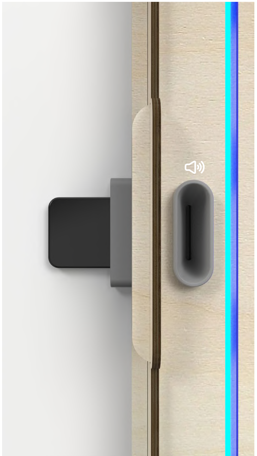
Fig. 32 Dato che l'approccio al gioco avviene dall'alto, nel totem del freddo l'amplificatore passivo direziona il suono verticalmente. Quindi, lo smartphone viene posizionato orizzontalmente rispetto al piano del terreno.
