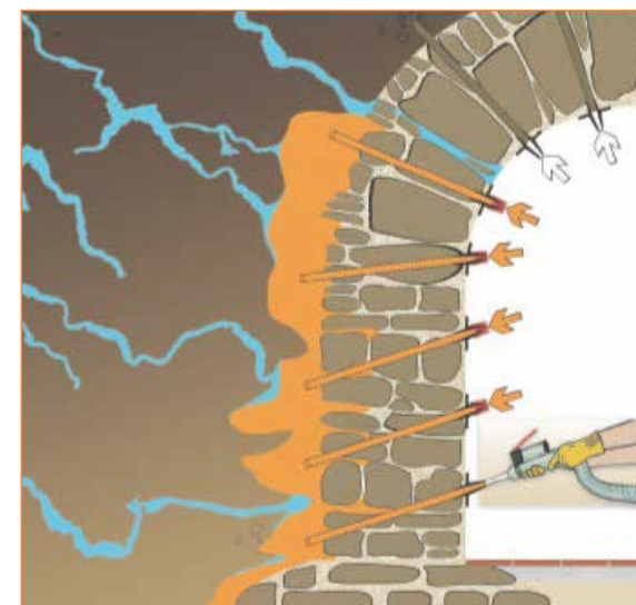
Operazione di iniezione
