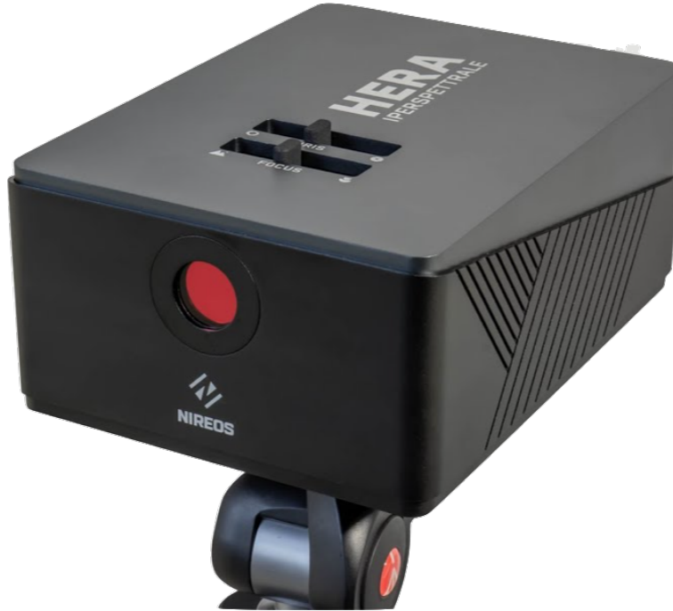
Figure 2.8: The HERA Iperspettrale hyperspectral camera.
