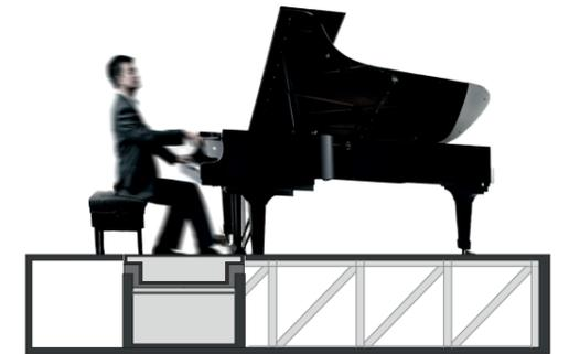
**c.** In questa rappresentazione il tavolo è totalmente inglobato nel palco. In questo modo lo spazio si presta a eventi più dinamici. Il sistema è meccanico, si basa su una struttura caleidoscopica e una reticolare come supporto alla struttura.
