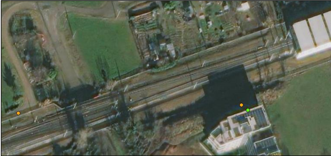
Figura 4.6: Posizionamento dei punti di misura in continuo in verde e posizionamento dei punti di misura spot in arancione effettuate durante la seconda campagna di misure.
