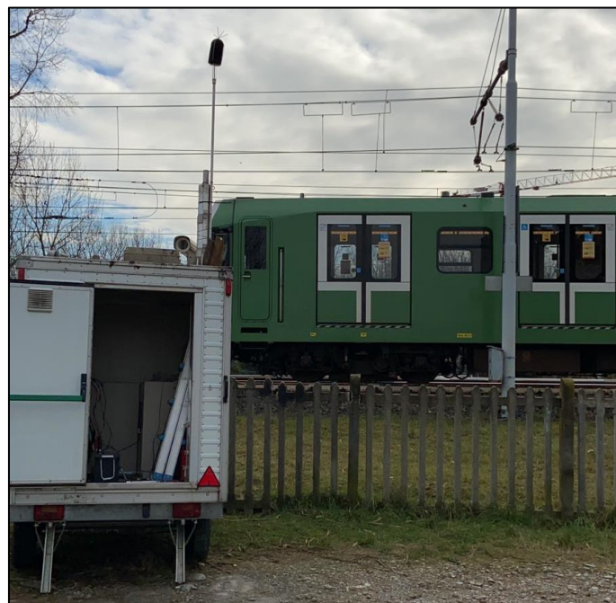
Figura 4.4: Mezzo mobile posizionato per la misurazione in continuo a lato dei binari.
