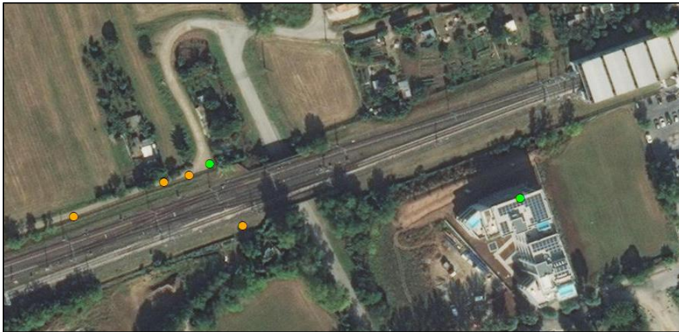
Figura 4.5: Posizionamento dei punti di misura in continuo in verde e posizionamento dei punti di misura spot in arancione effettuate durante la prima campagna di misure.
