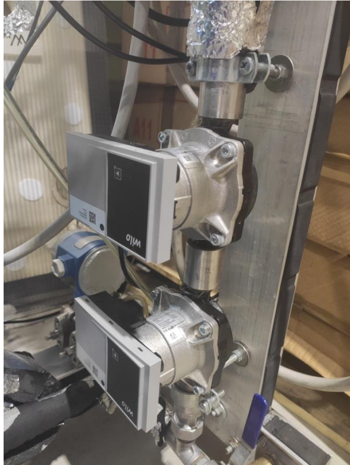
Figura 3.2: Pompe Wilo RS15/7.0-PWM1 in serie utilizzate per la movimentazione del fluido analizzato
