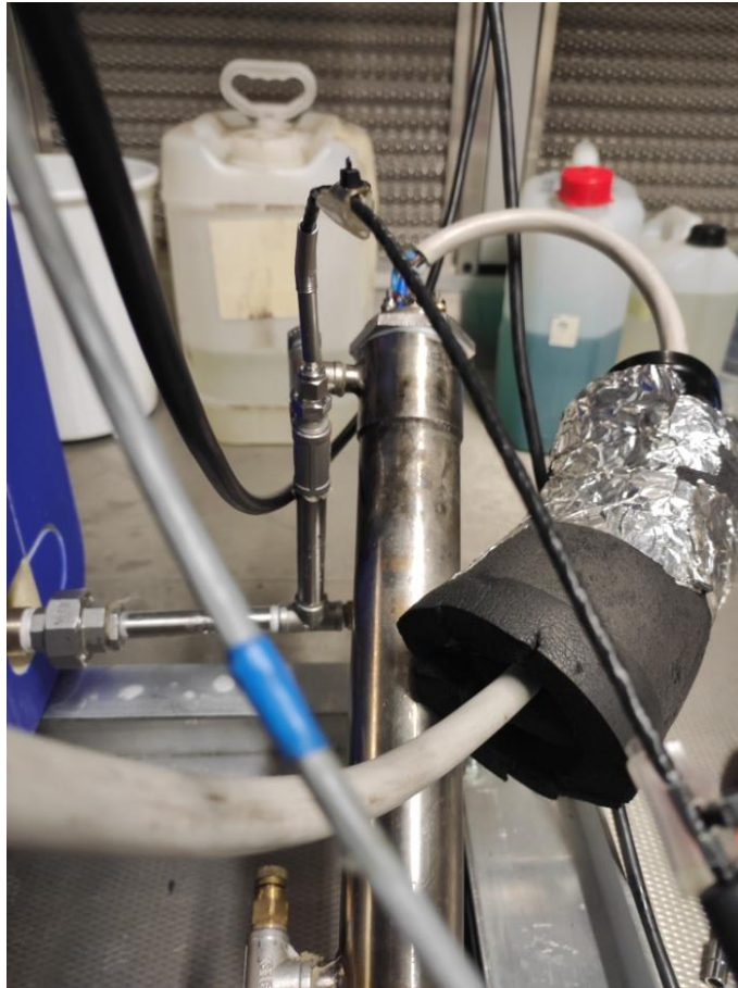
Figura 3.7: Resistenza elettrica da 6kW con alimentazione a 320V
