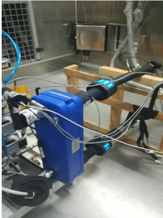
Figura 3.5: Scambiatore di calore a piastre collegato al calorimetro da 20kW a disposizione del laboratorio "Relab"
