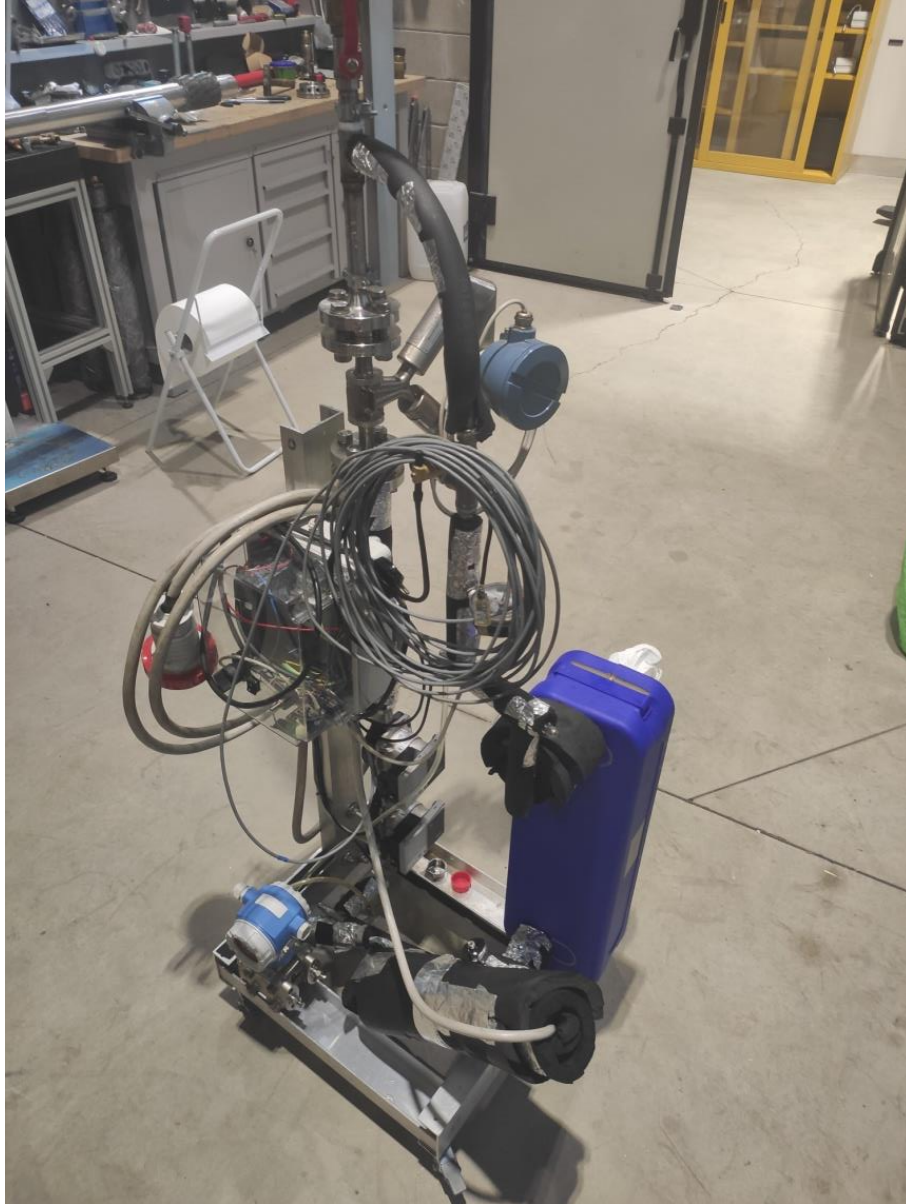
Figura 3.9: Banco prova definitivo in attesa del collegamento al calorimetro
