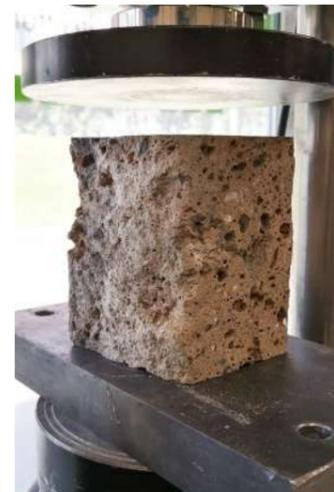
Fig.6.15. Blocco di tufo a seguito della prova di compressione.
