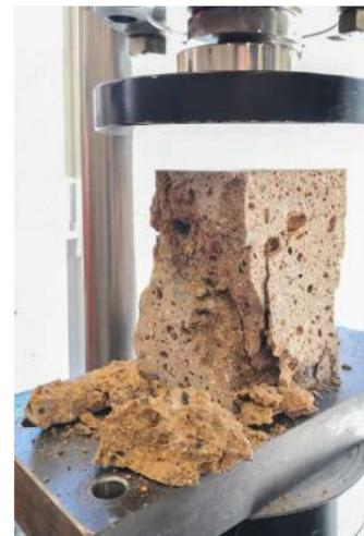
determinate le caratteristiche meccaniche dei blocchi di tufo. È stata, quindi, eseguita una prova di compressione monoassiale presso il laboratorio di materiali e strutture in calcestruzzo del Politecnico di Milano, dalla quale è emerso una tensione massima di compressione di 5,43 MPa.
