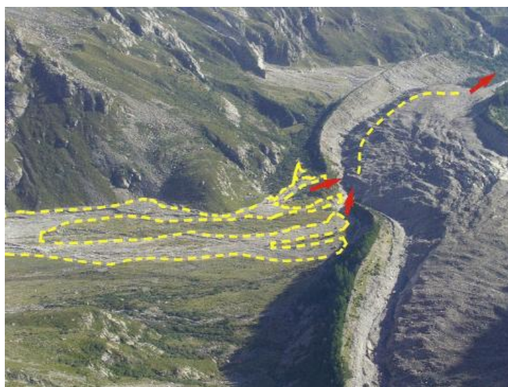
Figura 3: Limite dell'area alluvionata, la linea tratteggiata ipotizza il percorso endo/subglaciale della colata detritica; le frecce indicano le bocche di ingresso e uscita (f. da elicottero di T. Sala, settembre 2008)
