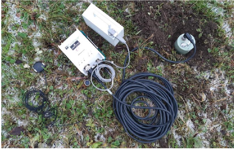
Figura 4.1. Sismometro, batteria, digitalizzatore, antenna GPS. Da “Analisi di fattibilità sull’utilizzo di metodi geofisici per lo studio della frana di Piuro (SO)” tesi di Anna Zinetti.
