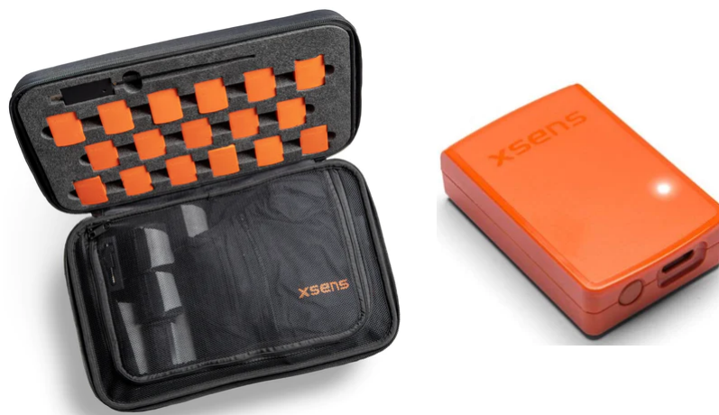
Figura 2.5: Sistema MVN Awinda per motion capture. Nell'immagine a sinistra viene rappresentata la valigetta con tutti i componenti, in quella di destra viene proposto un sensore MTw [50].
