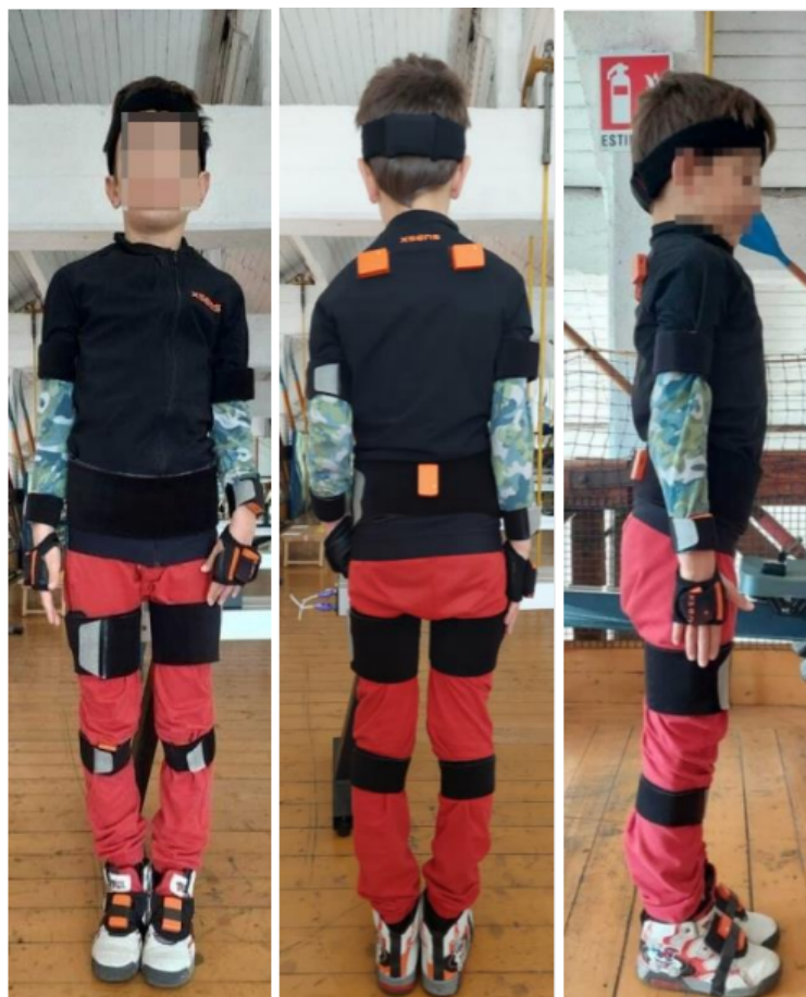
Figura 2.6: Posizionamento dei MTw secondo il protocollo fornito da MVN Awinda di Xsens [37],[51].
