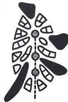
*Schema-diagramma della ricostruzione di una grande città. La costruzione indifferenziata a quartieri viene smembrata dalle zone verdi in grossi nuclei urbani dotati di centri autonomi. In alto sono indicate le zone industriali*
