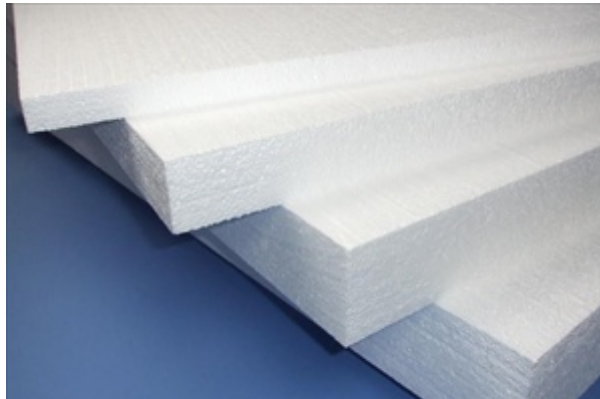
Figura 5 Pannelli in polistirene espanso sinterizzato
