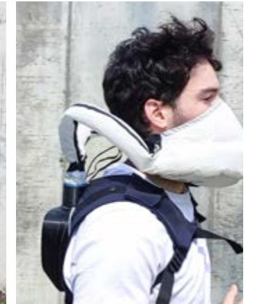
Se si è collegato uno strumento di misurazione del battito cardiaco allo smartphone, quest'ultimo invierà costantemente il dato misurato al purificatore, che di conseguenza regola l'intensità del flusso d'aria in modo che sia sempre adeguata allo sforzo.
