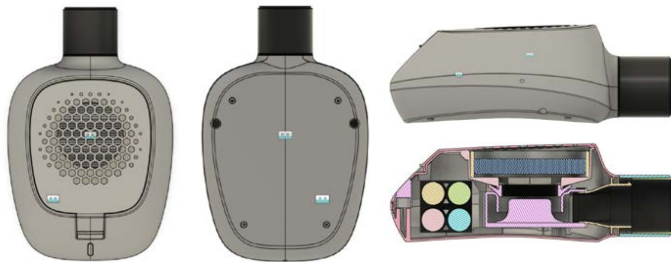
Figura 35 - dettagli della fase di ingegnerizzazione delle scocche di plastica
