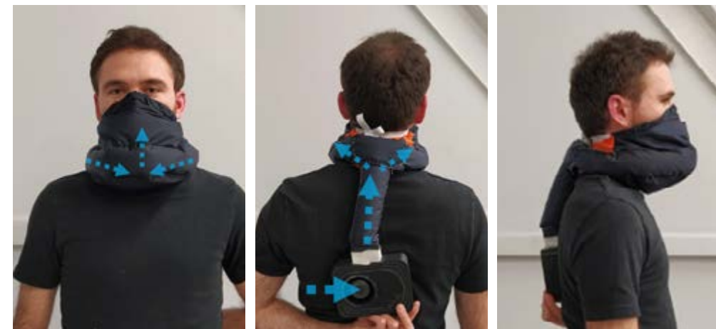
Figura 32 - prototipo preliminare per testare il nuovo layout della maschera
