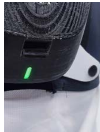
Una volta collegato, il dispositivo comunica all'app eventuali malfunzionamenti, il livello di carica della batteria, e il grado di saturazione del filtro. Quest'ultimo dato è ottenuto incrociando il tempo d'uso del prodotto, cronometrato a partire dal momento dell'accoppiamento via Bluetooth, e i valori di qualità dell'aria dei luoghi attraversati durante l'allenamento, forniti dall'app. Quando il collegamento è stabilito, la luce verde smette di pulsare e resta accesa.
