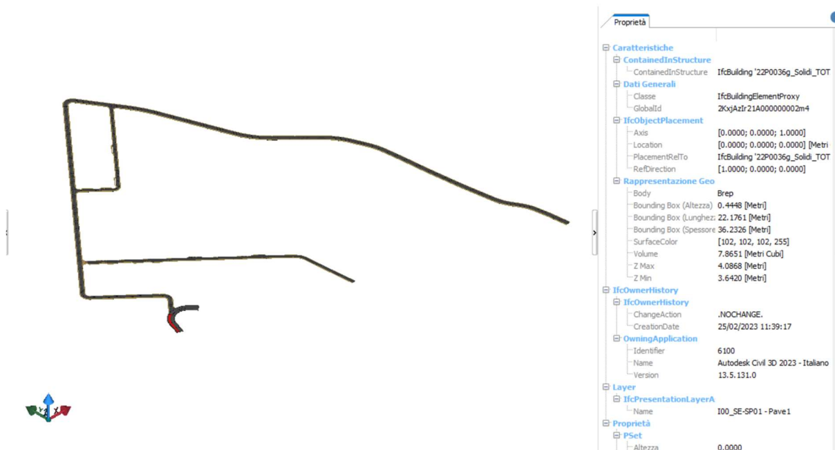
Figura 71: Visualizzazione del file IFC all'interno del software ACCA usBIM.viewer+ per il controllo della corretta compilazione del contenuto informativo
